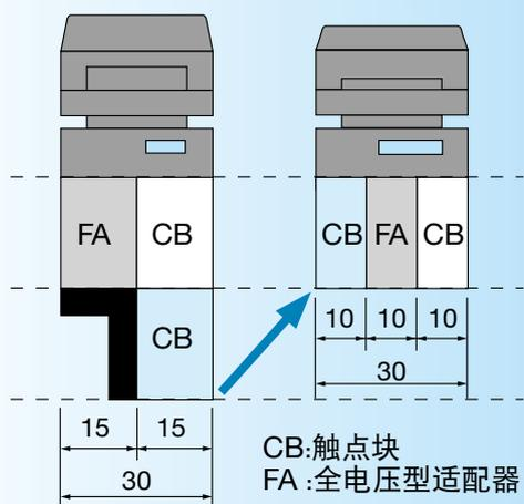
新型触点块结构大大缩小了控制元器件的面板后伸出长度。
