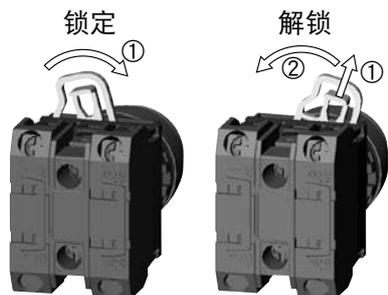
锁定时，只需将操作部与触点块部对齐，将销锁杆拨向右侧（背面看）即可。解除锁定时，只需将销锁杆往上拉，然后扳到左侧拉出操作部即可。
